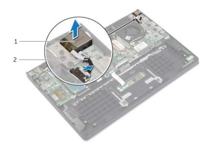
1 電源アダプタポート 2 電源アダプタポートケーブル
